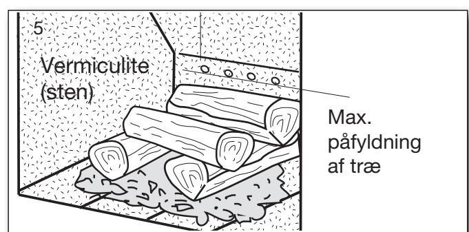
Indfyring af træet, skal holdes under rækken af lufthuller og inden for det yderste lufthul i hver side. Fig. 5.
