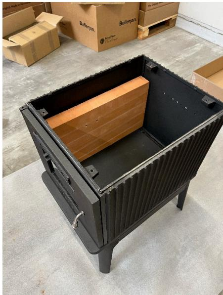
11. Setzen Sie zuerst die linke Seitenplatte aus Schamotte ein (1). Bitte achten Sie darauf, dass die zwei Bohrungen im Schamotte direkt über den Bohrungen in der Außenwand des Ofenkorpus liegen.
