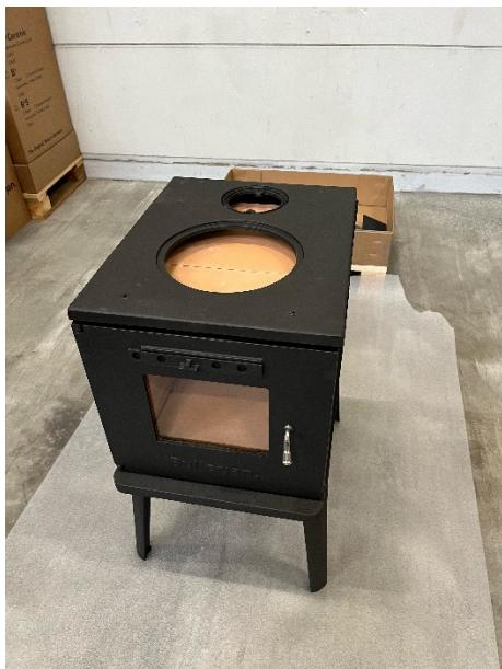
19. Setzen Sie den Ofenkörpusdeckel wieder auf und verschrauben Sie diesen.
