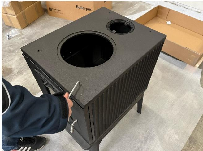
8. Lösen Sie bitte die vier Befestigungsschrauben des Ofenkorpusdeckels.
