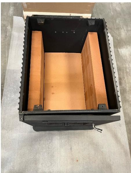
13. Nun bitte die Bodenplatte einsetzen.
