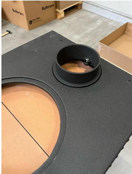
20. Montieren Sie den Rauchgasstutzen.
