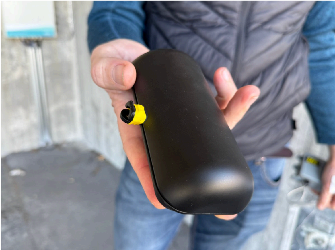
Slik ser boksen ut. Den festes på innsiden av pipeløpet. Den gule sikringen skal smelte når det utvikles tilstrekkelig varme i pipa, for deretter å slippe ut slukkepulver. Foto: Hans Martin Sveindal
