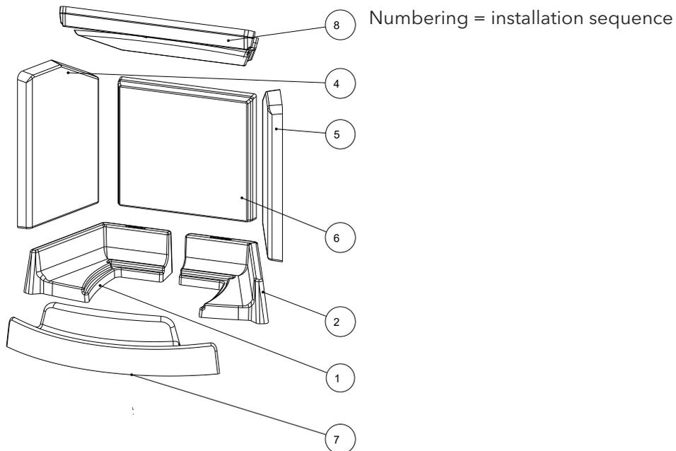
Fig. 50: Installing Keramott
