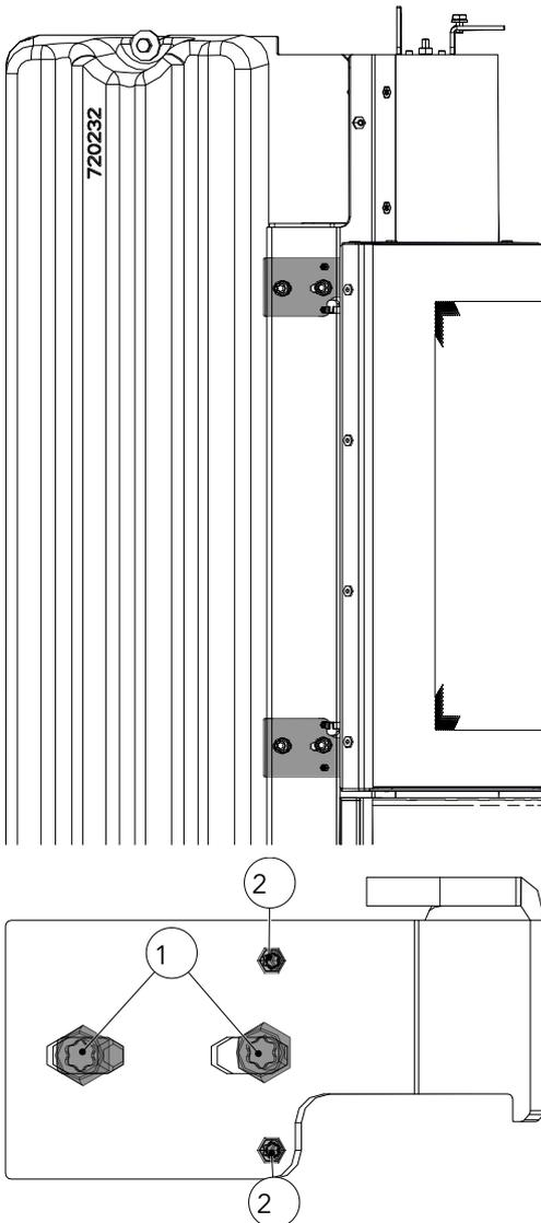
Fig. 54: Adjusting the door
