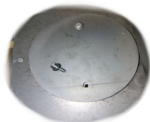
Fig. 18 Spænd dækslet med de tilhørende bolte.
