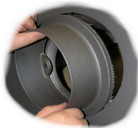
Fig. 9 Klip det lille stykke metal over, der forbinder dækslet med bagpladen med en skævbider. Vrid derefter dækslet af.
