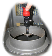
Fig. 12 Løsn boltene i røgtuden ovenud.
