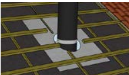
Eksempel på montert undertakskassett. Bilde viser montasje for bordtak men blir i prinsippet det samme med lekter og sløyfer
